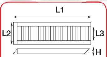
Formula per la valutazione della lunghezza in sicurezza delle rampe per il carico su camion di piattaforme aeree o altre attrezature
